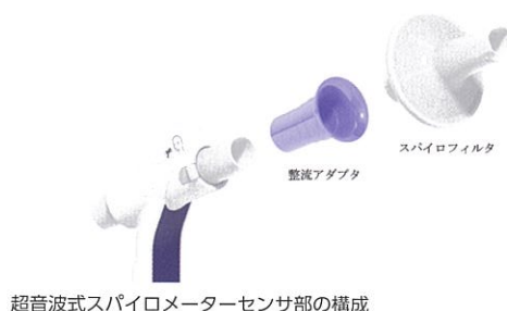
超音波式スパイロメーターセンサ部の構成
